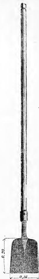
Fig. 118. — Vue de face de la binette à long manche de M. de la Rozière.
